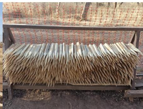
*Piquets fabriqués à base des rebuts de bois de la déchetterie pour les besoins de la topographie*
